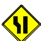
A-21 d Alargamento de Pista à Esquerda
