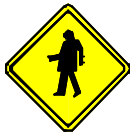
A-32 a Trânsito de Pedestres
