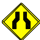
A-21 a Estreitamento de Pista ao Centro
